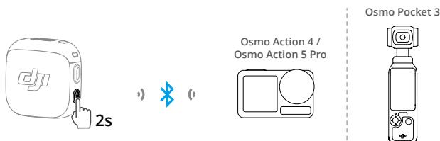
Acceda a la interfaz de configuración del sistema de dispositivos de grabación de DJI. Pulsa en **Micrófono inalámbrico** y añade el transmisor. La conexión se habrá realizado correctamente cuando el led de estado del transmisor se ilumine en azul fijo.
