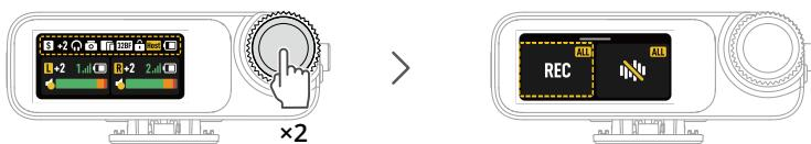
Cuando el cuadro punteado se mantenga en la barra de estado del transmisor, presiona el dial dos veces para ingresar a la interfaz de control de un solo transmisor.
